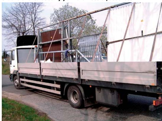
Nesprávné použití upínacího popruhu při přepravě stojanu s tabulovým sklem. FOTO: AUTOR
