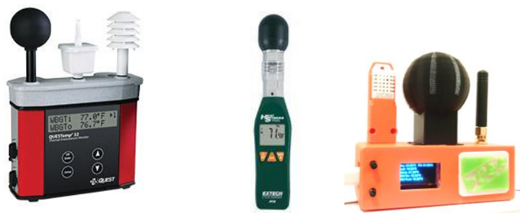
Obrázek 2 - Profesionální měřicí stanice – QUESTEMP ® 32-34-36 (1), poloprofesionální stanice – HT30-promo (2), open-source měřicí stanice (3) pro měření WBGT indexu pro vnější i vnitřní prostředí
